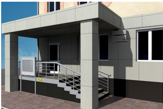
Рис. 17а. Крыльцо, включаемое в контур здания
