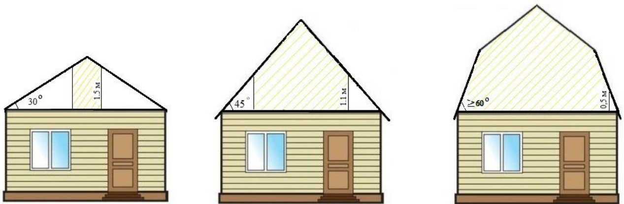
Рис. 9. Определение площади мансардного этажа нежилого здания
